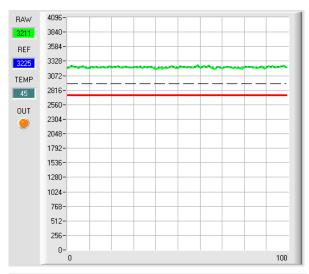
Solange der aktuelle Messwert RAW (grüne Linie) oberhalb der Schaltschwelle (rote Linie) liegt, ist der Ausgang **DIGITAL OUT** auf +24V (Signal ist in Ordnung). Dies wird über die Led **OUT** visualisiert
