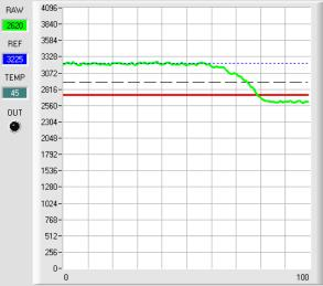
Wenn der aktuelle Messwert **RAW** (grüne Linie) die Schaltschwelle (rote Linie) unterschreitet, wird der Ausgang **DIGITAL OUT** 0V (Fehler). Dies wird über die Led **OUT** visualisiert
