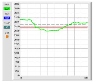
Wird der aktuelle Messwert **RAW** (grüne Linie) wieder größer als die Hystereseschwelle (schwarze Linie), dann wird auch der Ausgang **DIGITAL OUT** wieder +24V (Signal ist in Ordnung). Dies wird über die Led **OUT** visualisiert
